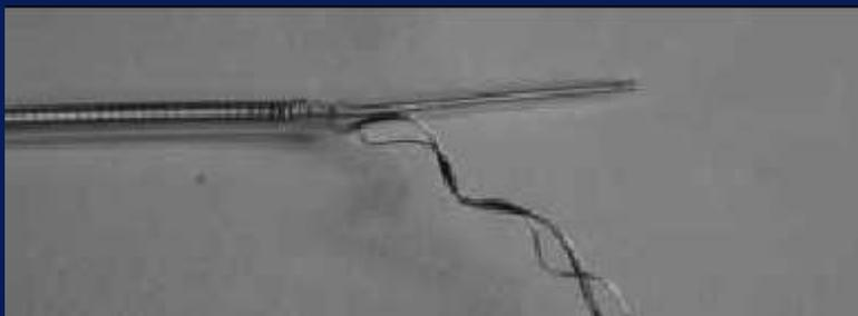
*Spire interne recouverte de son isolant totalement dégagée, le ressort externe est prêt à être sectionné*
